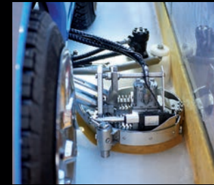
Бортовой фрезер Нержавеющая сталь, электронная регулировка по высоте
