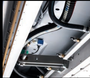
Система уборки льда Multijet с водосборной планкой
