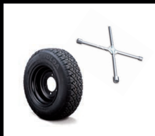
Запасное колесо 16" с баллонным крестовым ключом
