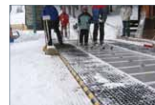
Посадочный конвейер с автоматической регулировкой по высоте
