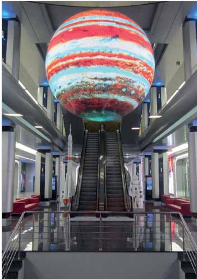
❖ ОКЦ «Галактика» (Красная Поляна). Светодиодный видеоскрин-шар. Диаметр 4 метра с углом обзора 360 градусов. Специализированное ПО позволяет отображать видеофайлы и конвертировать «плоские» изображения «на лету».
